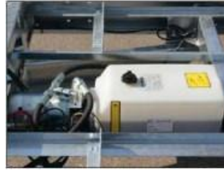
Bild 1.2: Kunststofftank / Ausf.: Elektro- & Kombipumpe
