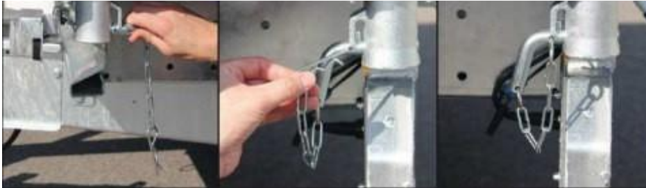
Bild 2: Sicherungsbolzen (nur diagonal umsteckbar)
