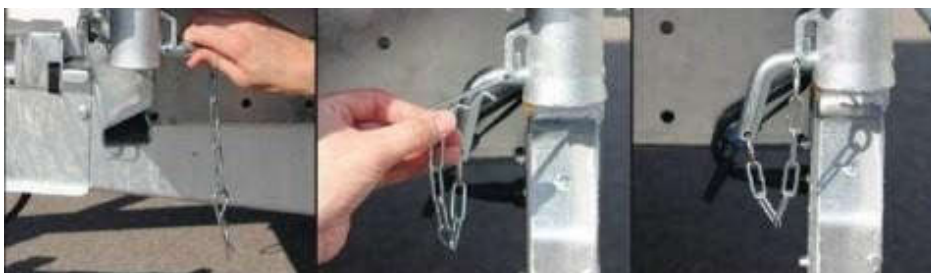
Bild 2: Sicherungsbolzen (nur diagonal umsteckbar)
