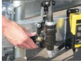
Bild 3.2: Senkventil / Ausf.: Kombipumpe (Hebevorgang nur bei geschlossenem Ventil möglich)
