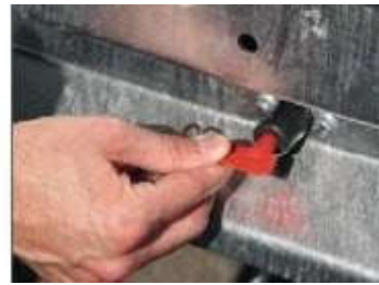
Bild 5: Hauptschalter auf EIN gestellt
