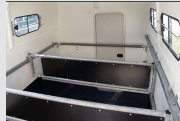
Teleskoptrennwand in der Länge verstellbar, Pferde fahren in der für sie günstigen Position: Rückwärts (Ausführung 1, 3 und 4)
