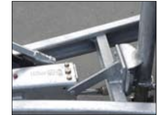
Sechskant-Außenrohr mit Dreikant-Innenrohr Einzerradaufhängung, wartungsfrei
