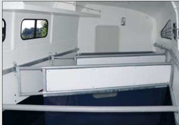
Teleskoptrennwand mit flexiblen Kunststoff Zwischenwänden (Ausführung 7, 8, 12)
