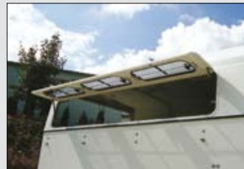
Panoramaklappen mit Fenstern, seitlich (durchgehend)
