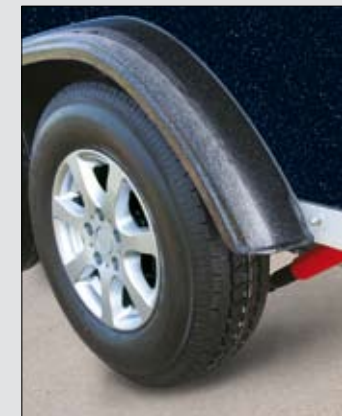
HALF-INSIDE-System: Räder halb außen – halb innen liegend, geringe Gesamtbreite, optimale Straßenlage
