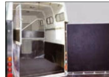
Heckklappe klapp- und schwenkbar
