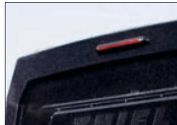
Bremsleuchte zusätzlich oberhalb Heckklappe
