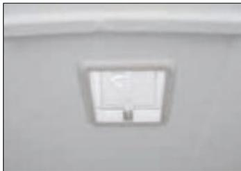
Dachluke mit Fliegengitter in Sattelkammer
